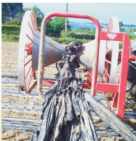
L'enrouleuse sans mandrin tire 5 à 6 bandes de paillage à la fois.
