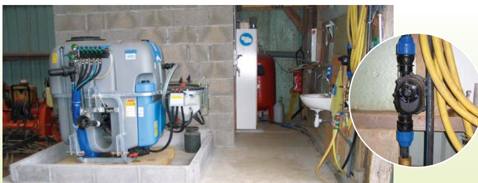
Une zone phytosanitaire mise en place et conçue par Joël Jacob à St Pol de Léon. Il ne manque plus que la potence à venir dans l'année. En médaillon, le volucompteur.
